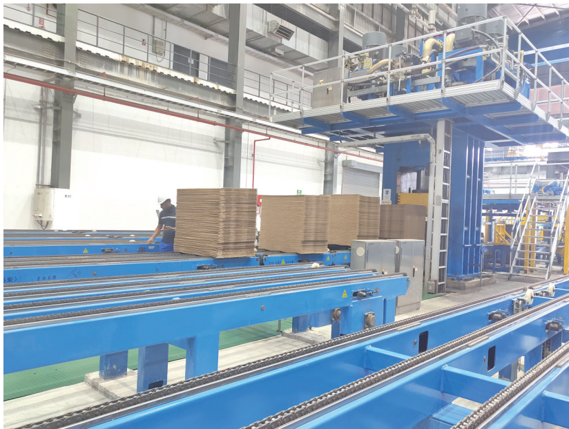
景兴纸业马来西亚控股公司分切完成以后的浆板，自动进入称重打包工序。
