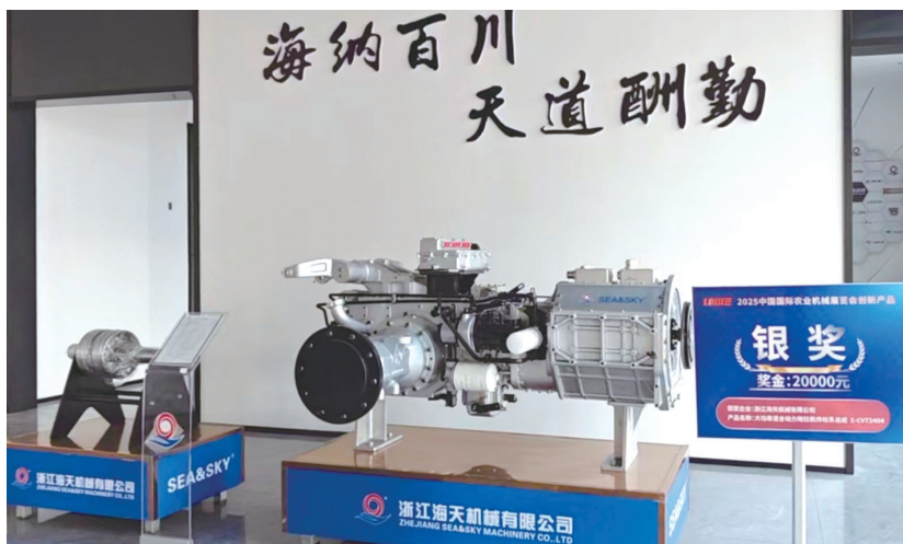
大功率混合动力拖拉机传动系统总成E-CVT2404。(祁晓玲 摄)
