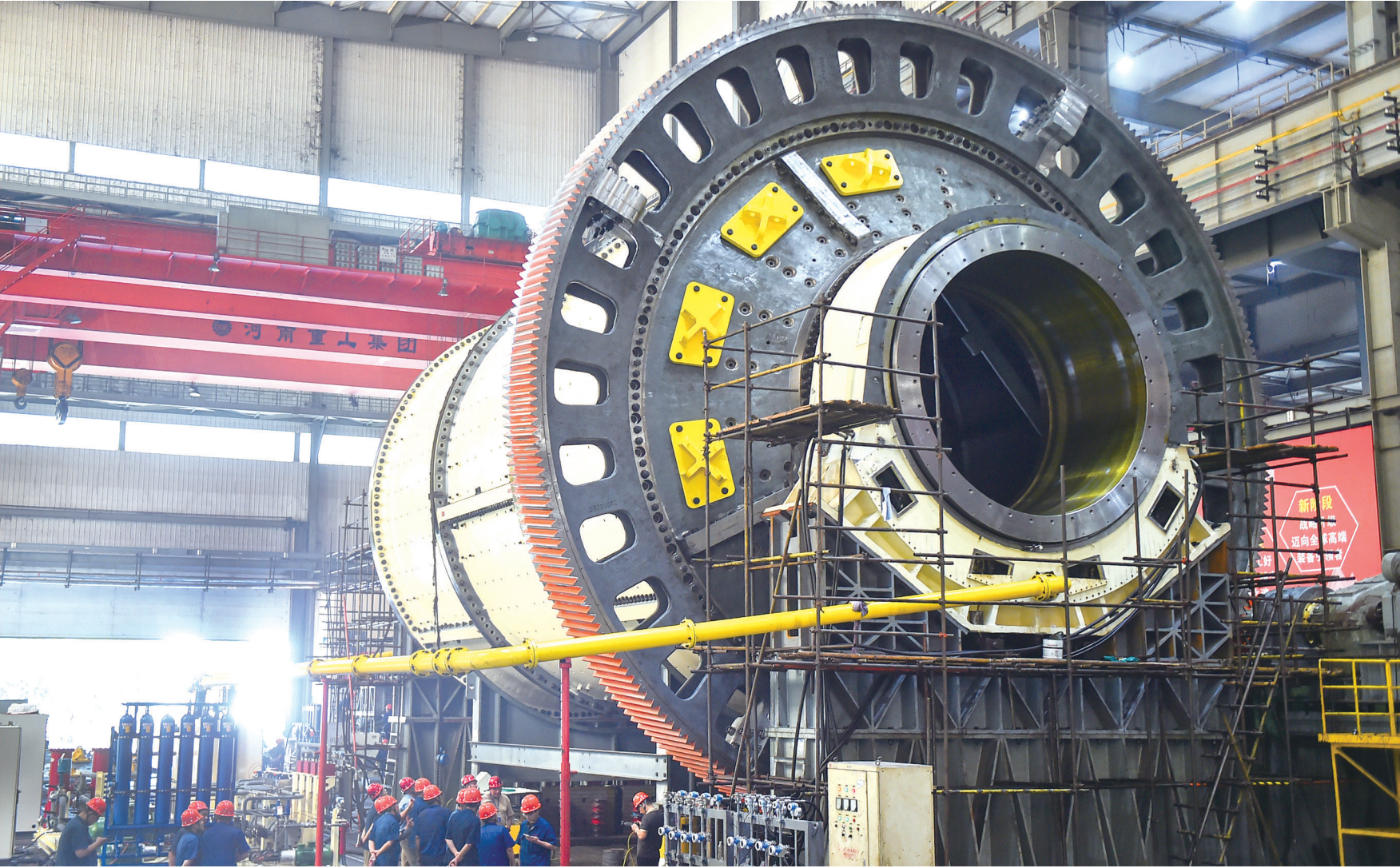
9月15日，国家统计局公布的数据显示，8月份，我国装备制造业增加值同比增长12.1%，高技术制造业增加值增长16.7%，分别快于全部规模以上工业增加值6.9和11.5个百分点。图为河南省洛阳市的中信重工总装车间内，由该企业自主研发出口海外的直径超8米的矿业领域大型矿石破磨装备球磨机正试车下线。（黄政伟 摄）
